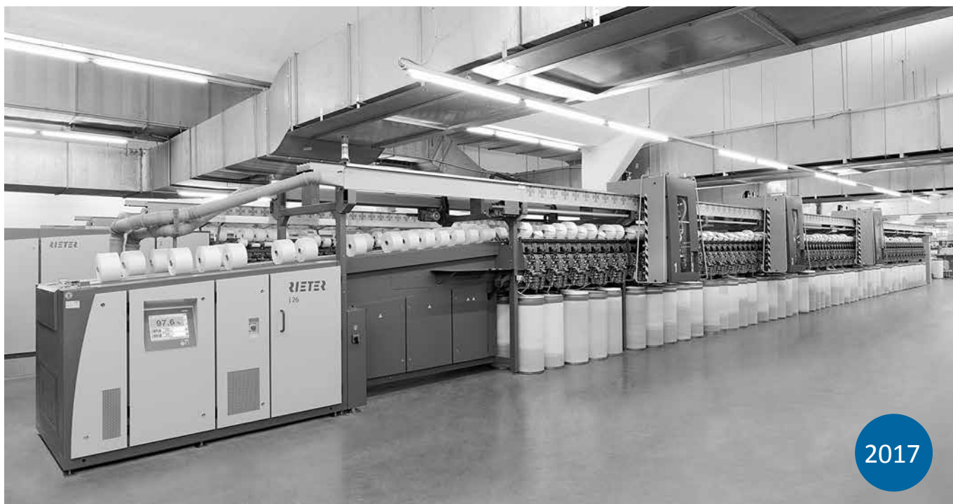
2017 – nejnovější model dopřádacího stroje J 26 s technologií tryskového předení.
