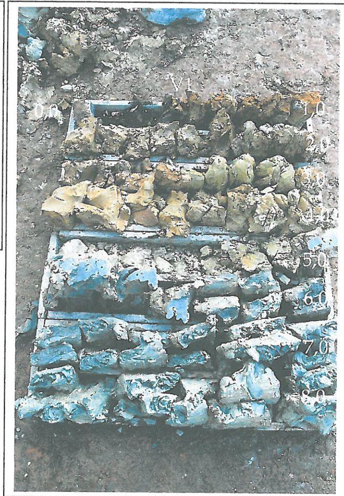
Foto 2 Hmotná dokumentace hornin z vrtných vzorků. Barevně jsou odlišeny vrstvy kvartérního pokryvu, tvořené jílovitými hlínami převážně žlutohnědých a okrově hnědých odstínů. Na rozhraní modrošedých terciérních jílu byla zastížena vrstva hrubšího hlinitopísčitého štěrku, kterými proudí podzemní voda.
