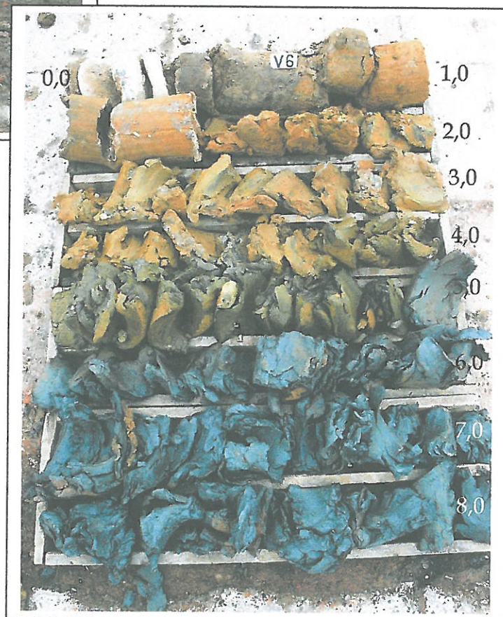
Foto 12 Ve vrtu V6 dosahuje mocnost kvartérního pokryvu jílovitých hlín téměř pěti metrů. Na spodu tohoto souvrství leží zřejmě poloha redeponovaného terciárního jílu se zahnětenými křemennými valouny. Dále pak pokračuje souvrství vysoce plastického jílu
